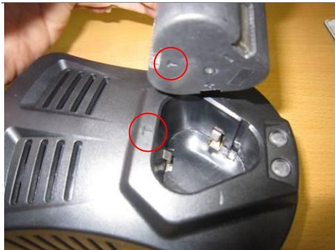
2. 电池包在充电状态时，充电座上左边的红灯会亮起，充电时间大约1~1.5小时，电力充满之后，红灯熄灭，右边的绿灯会亮起，请移除充电电源插头。(加示意图)
